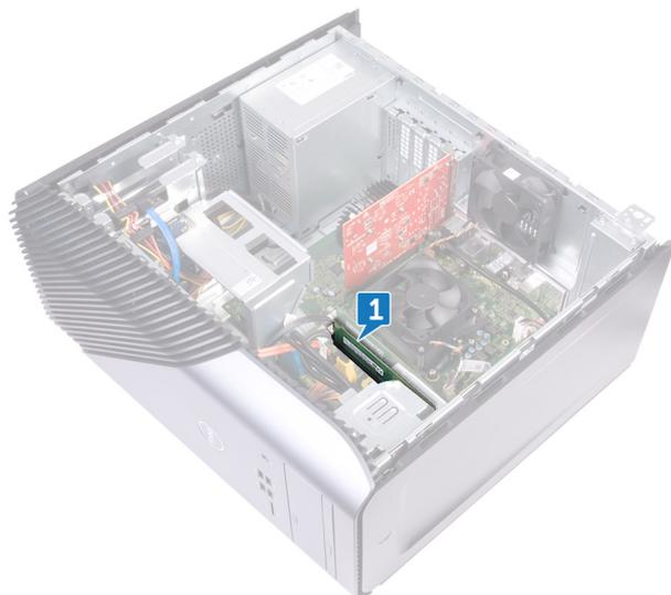
2. Con la yema de los dedos, separe los ganchos de fijación de los extremos de la ranura del módulo de memoria hasta que el módulo salte.
