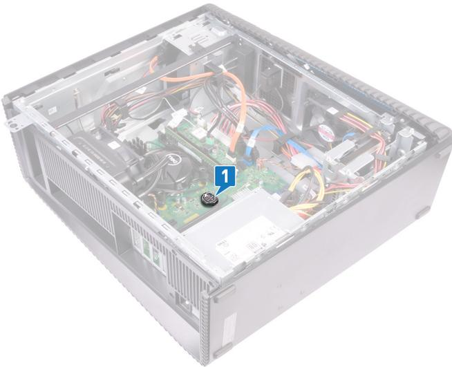
2. Presione la lengüeta del zócalo de la batería de tipo botón.
