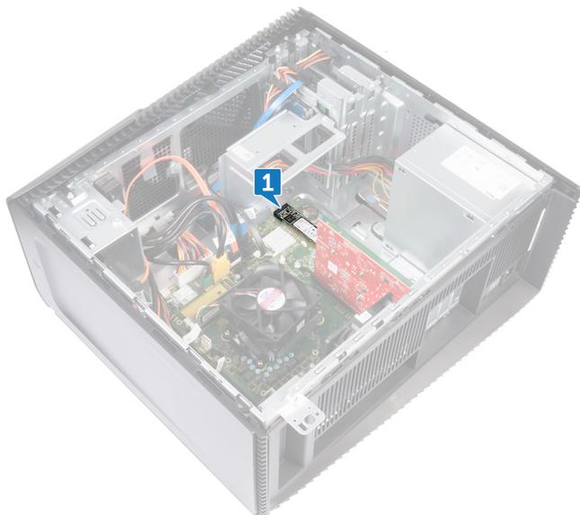
2. Extraiga el tornillo (M2x3.5) que fija la unidad de estado sólido a la placa base.
