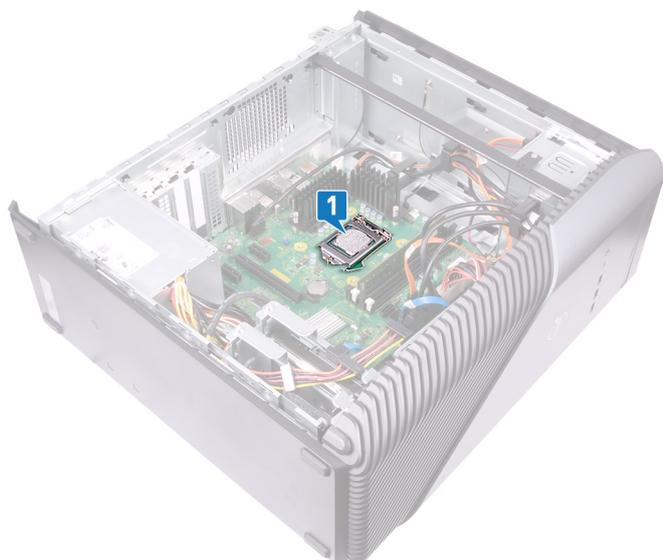
2. Presione la palanca de liberación hacia abajo y apártela del procesador para liberarla de la lengüeta.
